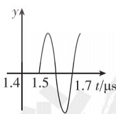
图(c) 缺陷表面反射信号
